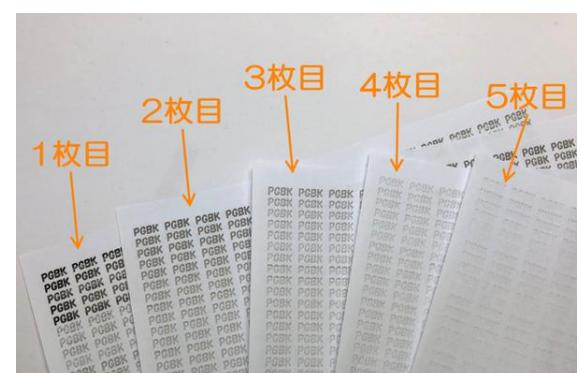
洗浄カートリッジをセットして印刷を行うと、インクの代わりに出てくる洗浄液が、ノズルに残ったインクを洗い流してくれます。
